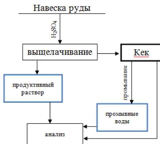
Рисунок 20 - Схема исследований прямого выщелачивания окисленной цинковой руды
