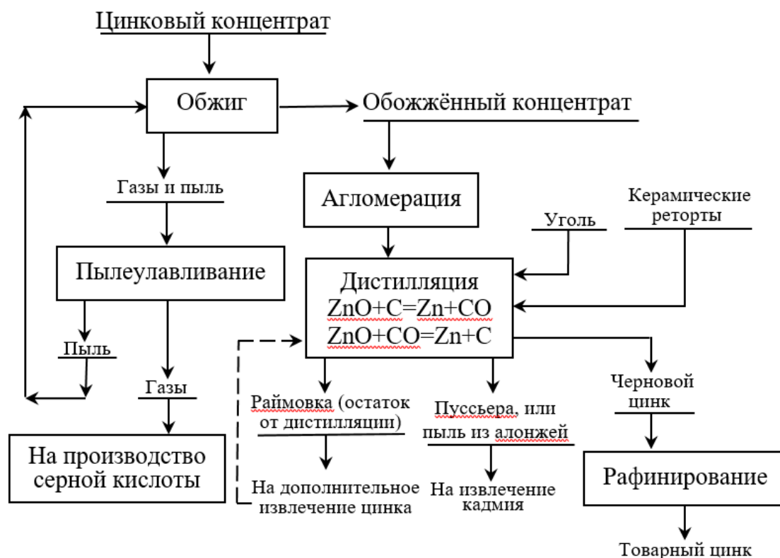
Рисунок 1 – Схема пирометаллургического способа получения цинка
